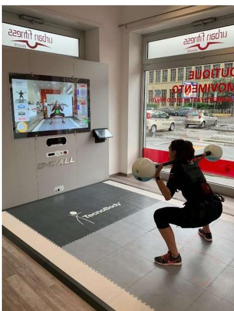
**D-WALL:** si tratta di un muro digitale (Digital Wall). Una videocamera 3D riporta su un monitor in tempo reale i valori legati al baricentro, all'appoggio plantare e alla distribuzione del carico. Inoltre si possono verificare le calorie bruciate e la corretta esecuzione degli esercizi grazie all'analisi segmentale.
